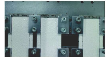
JASS8 疲労試験 3000回振幅後の状態
