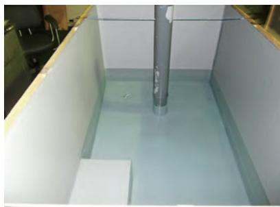
屋根想定水張り試験で漏水なし
